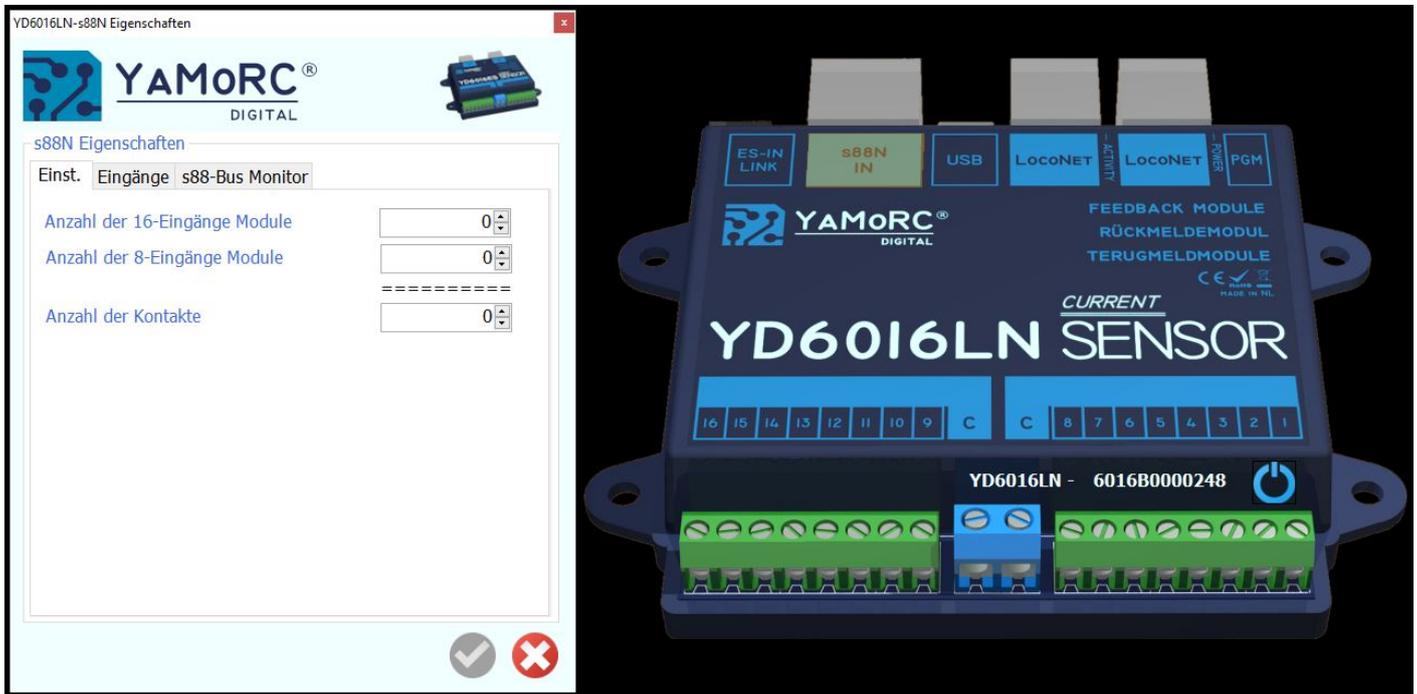
Ist die Anzahl der s88N-Rückmeldemodule ungleich 0, werden auf dem "Eingänge" Tabulator die s88N-Rückmeldereingänge angezeigt. Hier können die Rückmeldeadressen und Aktion bei Rückmeldung angepasst werden.
