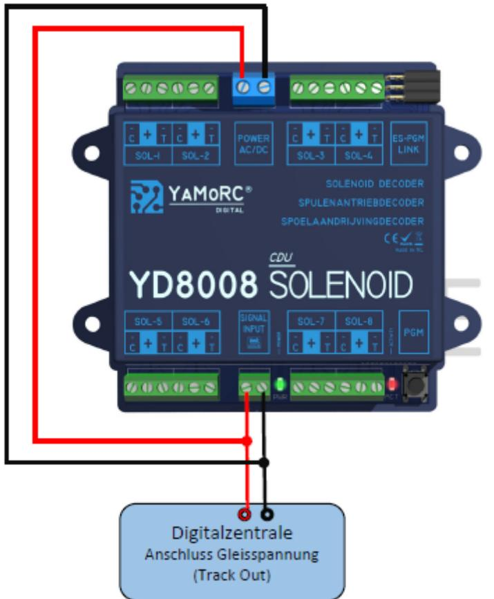
Spannungsversorgung des YD8008 über ein separates Netzteil (DC) oder einen Trafo (AC) mit min. 500mA Ausgangsstrom.
